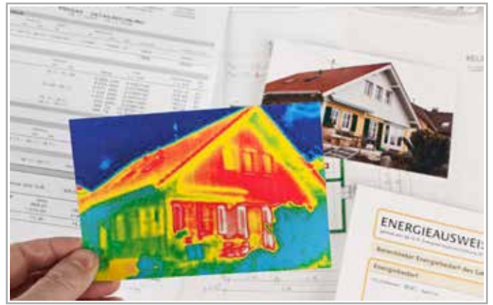
Abb 5, Wärmebild einer Fassade
