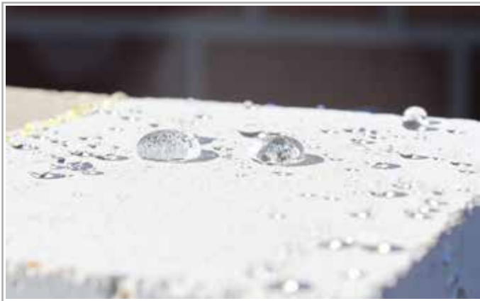
Abb. 4, Lotuseffekt nach der Imprägnierung
